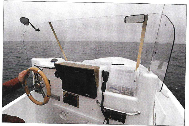
Pour l'homologation routière, le Tringa est équipé de rétroviseurs et d'un pare-brise protégeant efficacement des embruns en navigation.
