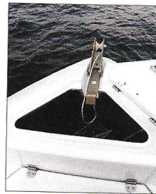
La baille à mouillage est pourvue d'un davier rabattable. Un vaste coffre est accessible sous la plateforme avant.
