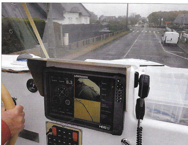
Une caméra située sous la proue du navire et connectée au combiné Lowrance HDS12 permet de voir ce qui se passe devant l'étrave.
